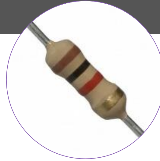
مقاومة ذات الجهد 10K\Omega
