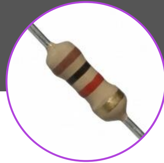
مقاومة ذات جهد 1K\Omega
