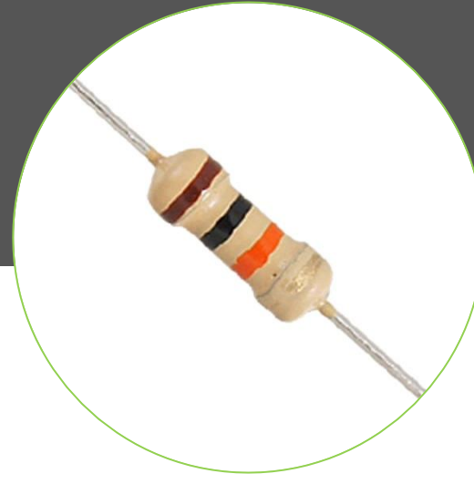
مقاومة ذات جهد 10K\Omega
